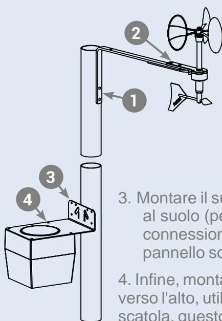
1. Montare la staffa a L su una parete, o su un palo che verrà utilizzato per sostenere l'anemometro. Assicurarsi che sia rivolto esattamente a nord
